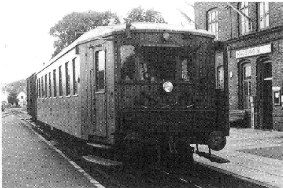
RHJ M 1 (=M 2) "stor" Kielervogn, omtrent = de fynske vogne. Vognen på billedet har fået postrum, det fik begge omkring 1950. Hadsund 1964. JS A 3 05 F 068.
