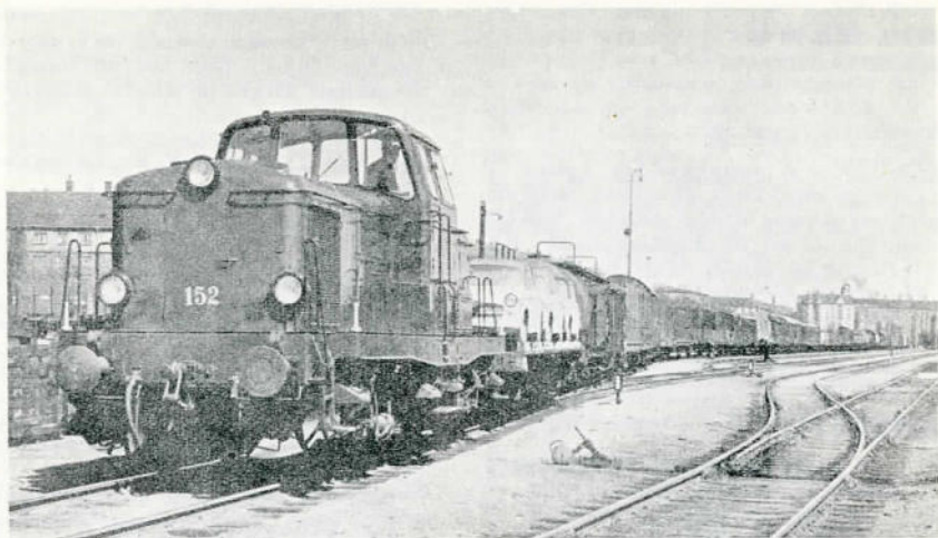
MT 152 under optræk på rangerbjerget på Københavns Godsbanegård med 110 aksler og 1047 t.
