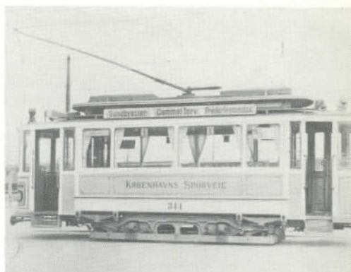
Fig. nr. 2. Motorvogn med store, lukkede perroner.
