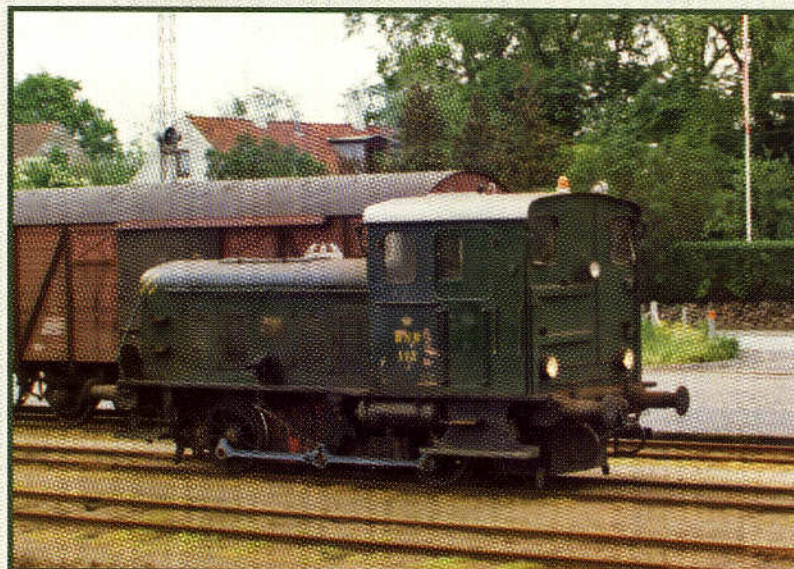
De fleste Ardelt-traktorer havde sølvgrå kobbelstænger, men bl.a. Ardelt 112, der her rangerer i Vordingborg, 1978, havde lyseblå kobbelstænger.
