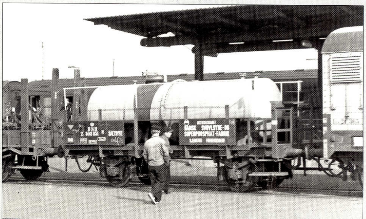
DSB litra ZE 508 051 rangerer på Korsør station, maj 1959. Vognen blev i 1940 opbygget på en undervogn fra Stubbekøbingbanen. Foto: JB-P.
