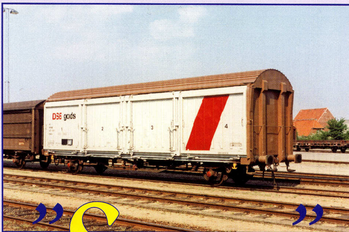
DSB Hbikks 42 86 237 8 121-1 i Padborg, maj 1993. Bemærk de gule færgekroge og røde akselkas- ser. Skydevæggene var malet i grå RAL 7035, mens gavle og tag var i brun RAL 8025. Det røde bånd var i rød RAL 3003. Bemærk, at vognen har firkan- tede puffer. Foto: Jan Lundstrøm
