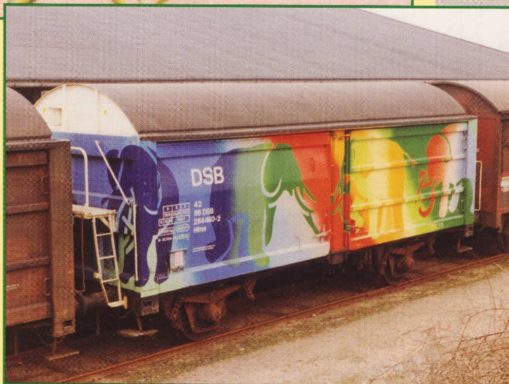
Herover: DSB litra Hims 42 86 211 4 460-2 (Elefant- vogn), Næstved 1984. Bemærk, at vognen har to for- skellige dørtyper. Foto: JSL.
