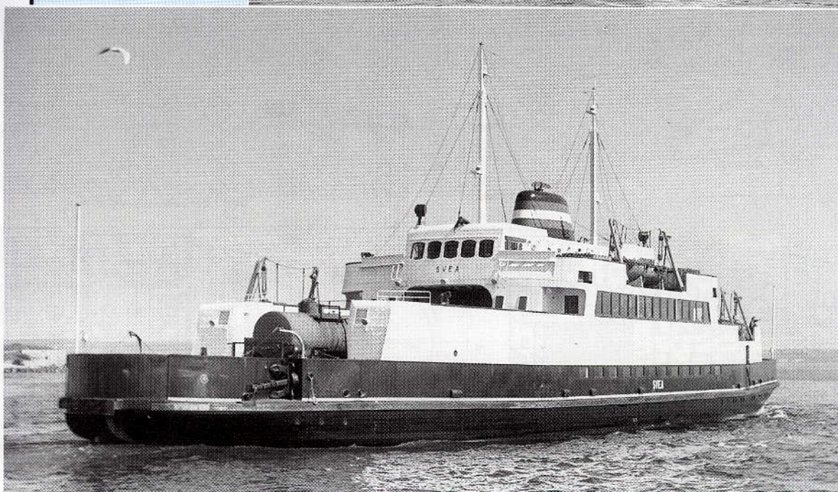
M/F SVEA på vej ind i Helsingør havn efter en tur over Øresund, 1967. Færgen er symmetrisk opbygget med to stævne og porte, så den kan lægge til i begge ender. Foto: JS/DMJK.
