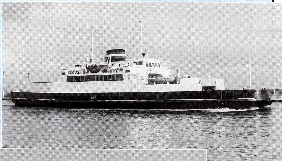
M/F SVEA på vej ind i Helsingør havn efter en tur over Øresund, 1967. Færgen er symmetrisk opbygget med to stævne og porte, så den kan lægge til i begge ender. Foto: JS/DMJK.
