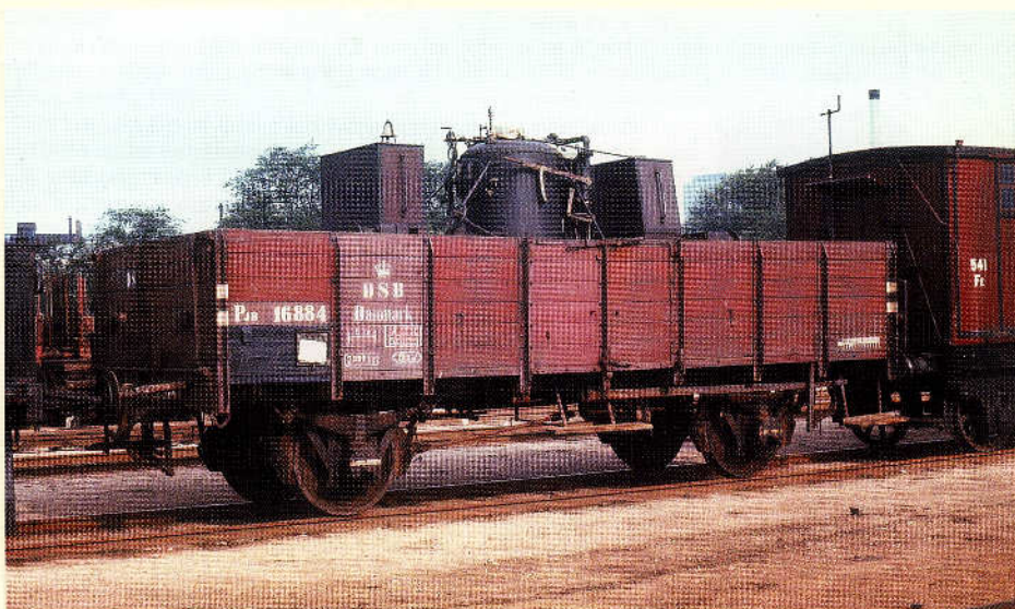
Den åbne vogn litra PJ var meget benyttet hos Statsbanerne. Det var en bred type, der på optimal vis udnyttede fritrumsprofilen. Selv om vognens løbeværk var lidt forældet, så blev flere undervogne i 1950'erne benyttet til ombygning for nye og andre vogntyper, bl.a. litra HJ og sukkervogne litra U. På billedet holder PJB 16 884, forsynet med trykluft- og håndbremse på København Gb, 1957. Foto: JS/DMJK.
