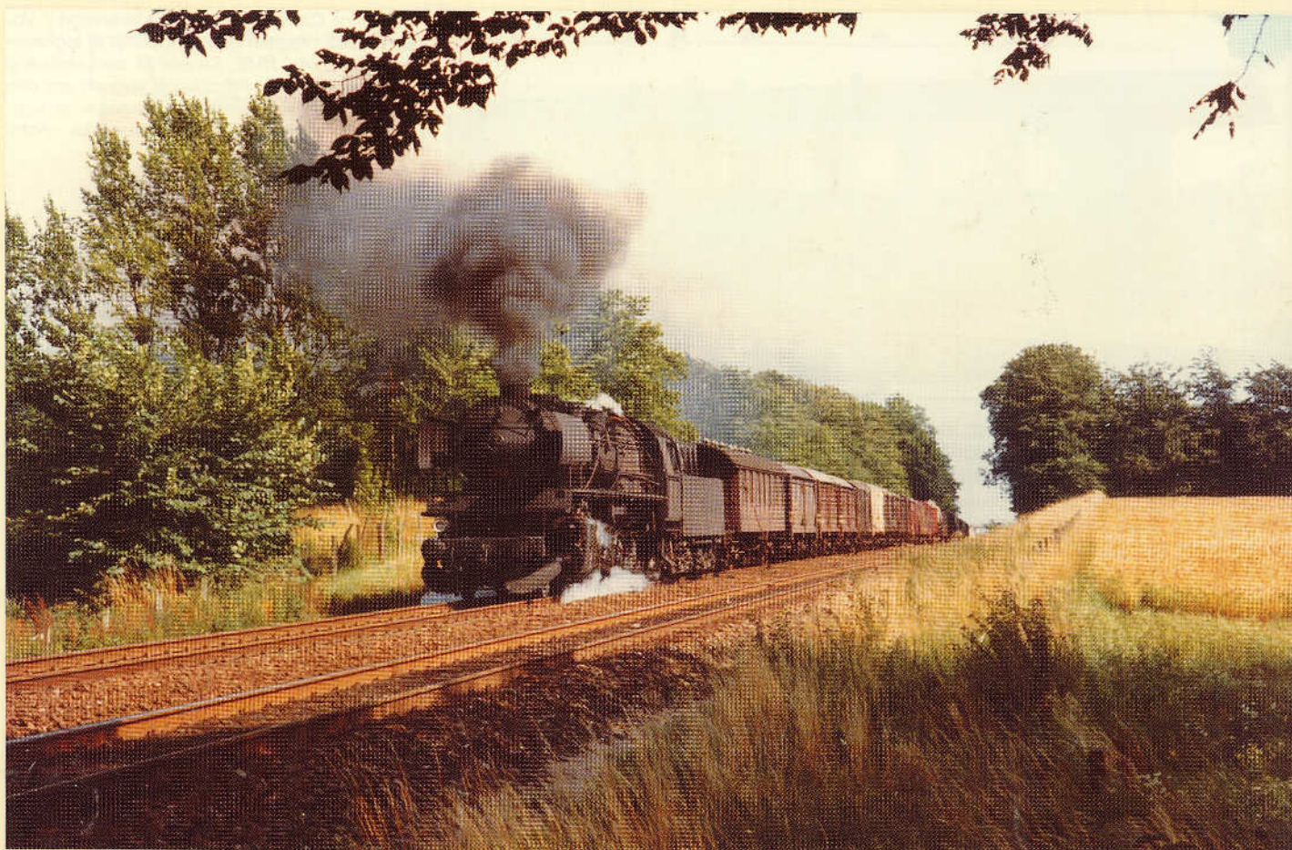
Endnu i midten af 1960'erne var de to- og treakslede CU-vogne i brug som togførevogne i dampfremførte godstog. Her benyttes typen i tog fremført af N 205 på vej til Odense fra Nyborg 1967, hvor vognen er oprangeret lige efter maskinen. Foto: HGC.
