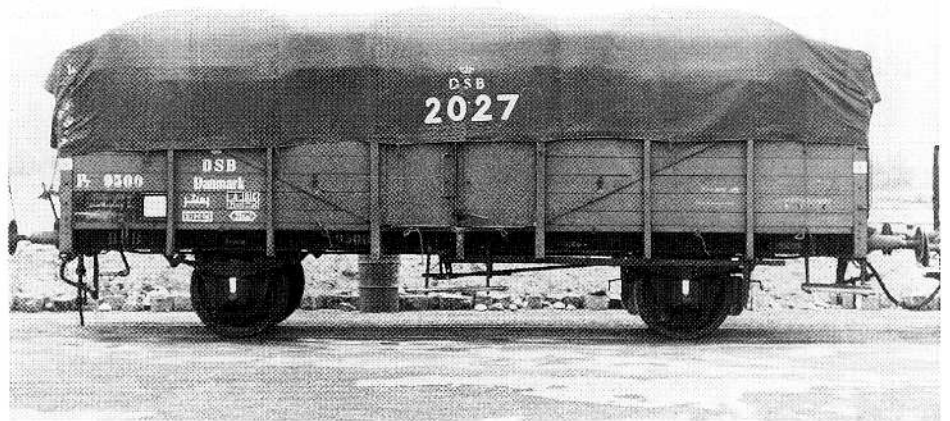
DSB litra PT og PTR var en åben vogn med meget høje sider, næsten så høje som en lukket godsvogn, og kunne derfor rumme en stor mængde gods. I løbet af 1950'erne fik vognene støtter for presenning, så de kunne transportere kunstgødning i løs vægt uden at godset blev vådt el.lign. PT 9500 i Masned Sund, 1964. Foto: JB-P.
