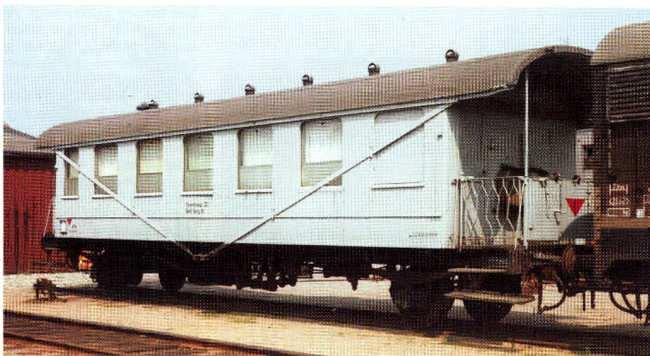
"Rystevognene" tjente DSB gennem mange år. Efter at have fornøjet de rejsende på Kystbanen - og flere andre steder - fik DSBs togførere glæde af dem. Da vognene omsider blev anset utjenlige til persontransport, blev en del af dem omdannet til specialvogne. Her er vi i Vejle, hvor en gråmalet CU fungerer som Specialvogn 322, fotograferet i 1978. Skråbåndet blev monteret som forstærkning og for at sikre at vognkassen fulgte med undervognen! Foto: TA.
