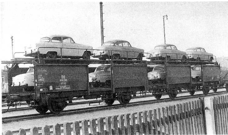
En typisk udenlandsk vogn op gennem 1950'erne og til langt ind i 1970'erne var biltransportvogne litra Off, der "drænede" vor valutakasse med importen af de mange biler, som kom til landet i efterkrigstiden. Litra Off 52 var ombyggede Omm-vogne, der bl.a. fik monteret sliker i øverste etage, og kørte i fast sammenkoblede enheder to og to. Foto fra Århus, 1955. PEC/DMJK
