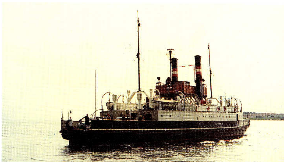
Den enkeltsporede færge "Glyngøre" er en af vore mest kendte jernbanefærger, og er meget velegnet som forbillede til modelfærge. Færgeren var konstrueret med såkaldt svævende kommandobro og to skorstene med de karakteristiske rød/hvide DSB-slips. "Glyngøre" er her fotograferet på Mommark Færge-Faaborg overfarten, 1961. Foto: HGC.
