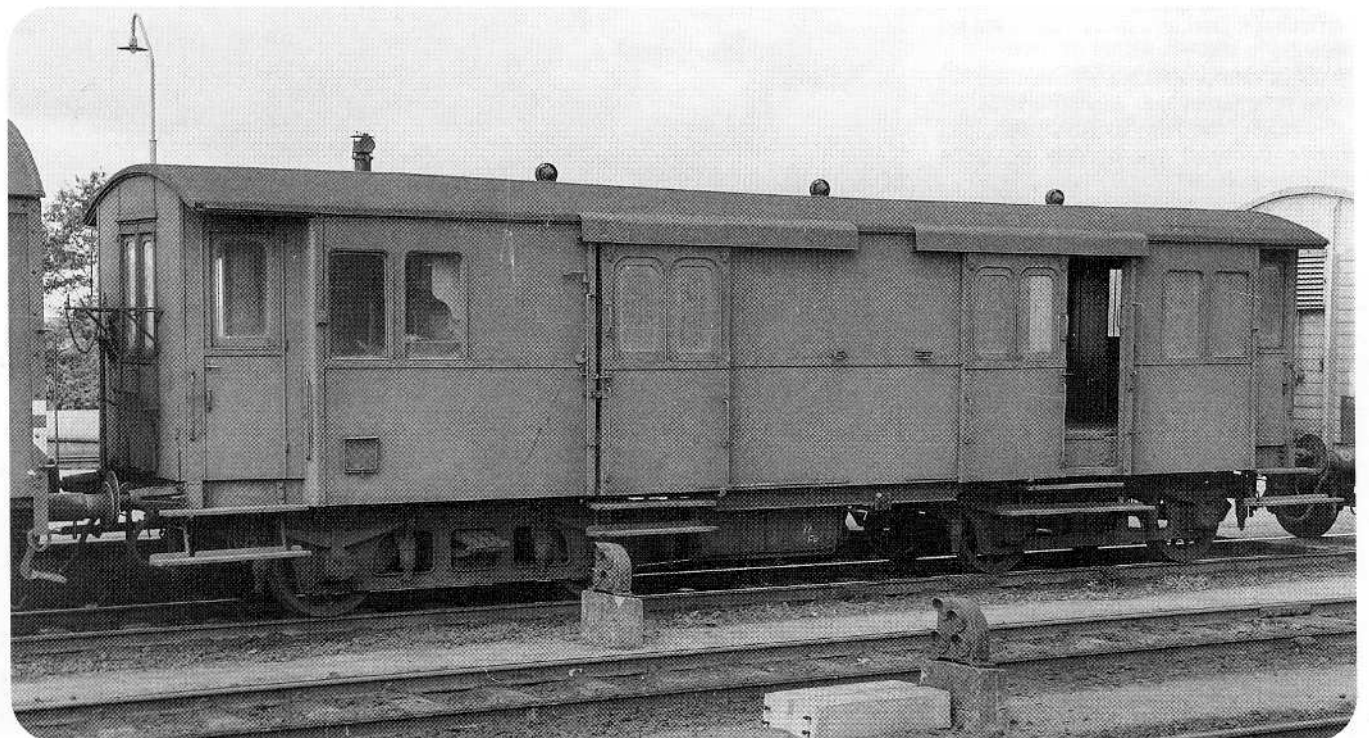
Flere ECO fik undervejs monteret 2,5 m berliner-bogier, d.v.s. bogier i stål. På billedet ses ECO 6301 med sådanne bogier. Vinduerne har tynde rammer, mens der er bredere vinduesrammer i dørene. Litrering og tekniske påskrifter er forsvundet efter slid m.v., og de mangler fuldstændigt. Fredericia 1960. Foto: H.True.
