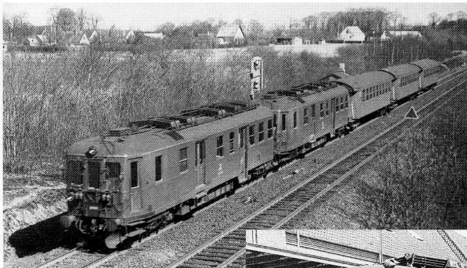
To ukendte MO i 1800-serien i forspand på Korsørbanen, 1963. Personvognene er tre litra CL fra den københavnske nærtrafik. Bemærk, at MO-vognene endnu har gitter for vinduerne i førerrummet. Foto: HBDS/PS.
