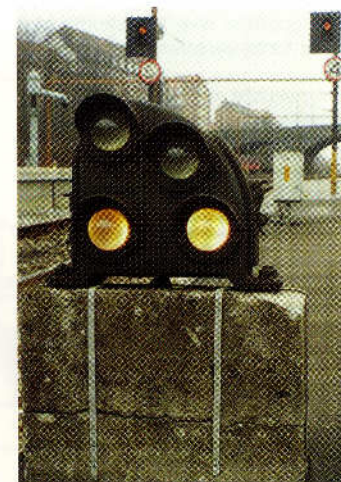
Ældre dværtsignal type N1 på betonfod. I baggrunden TU-signaler type T2. Århus H 1998.
