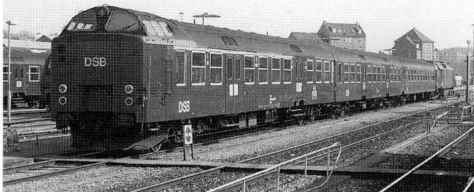
Litra ADns blev ombygget fra Bns fra ca. 1988, og fik som ABns lukket front og trippel-ventilation i taget. Typen kunne rumme 31 siddende på 1. klasse, mens resten af vognen var indrettet med rejsegodsrum. Næstved april 1994. Foto: TA.
