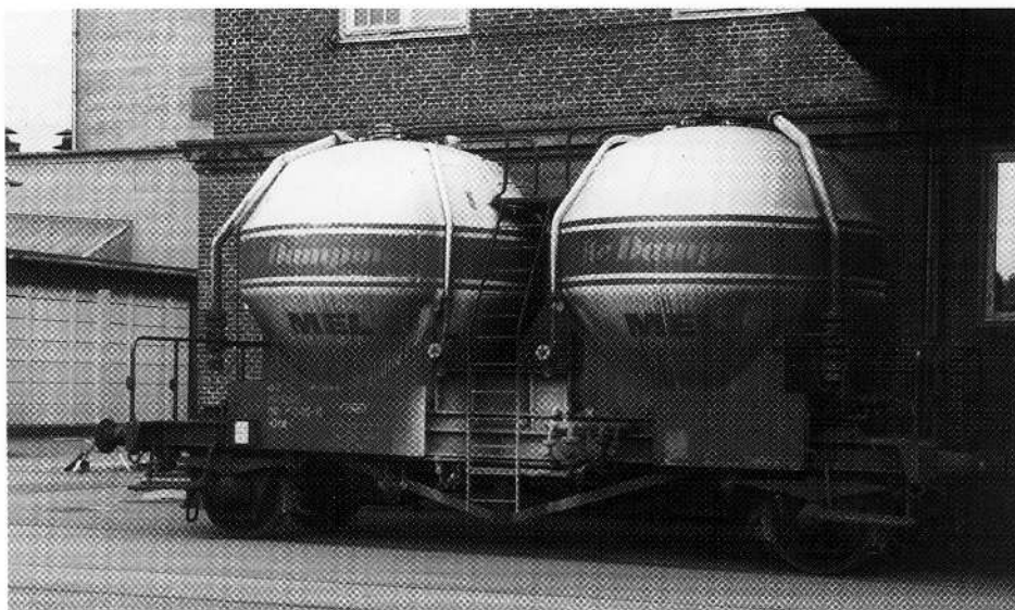
Ucs 910 6 045-6 fra Vejle Dampmølle på Vejle havn, 1985. Vognene kørte med mel i rutefart mellem Vejle og FDB i Glostrup.
