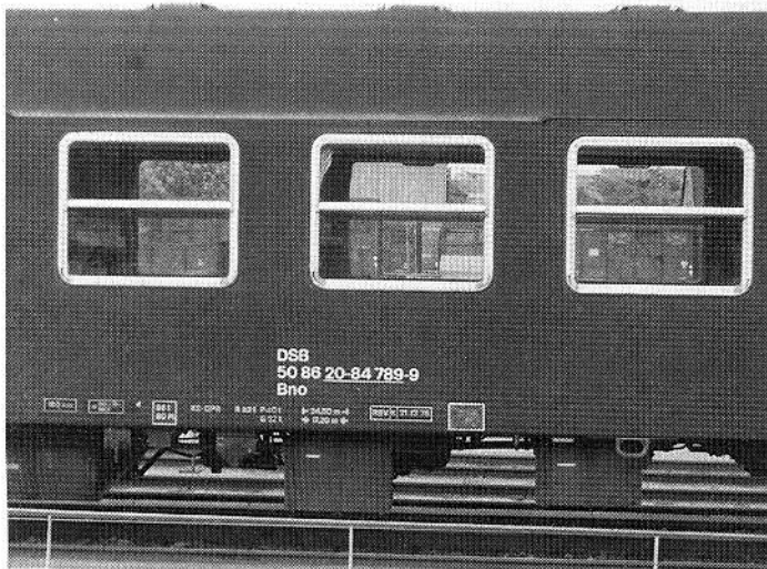
Litrering og tekniske påskrifter på litra Bno, vogne med styreledning A+B til MO-vogne. Typen blev efter 1978 anvendt som normal Bn-vogn, her i tog i Næstved, juni 1978. Foto: TA.
