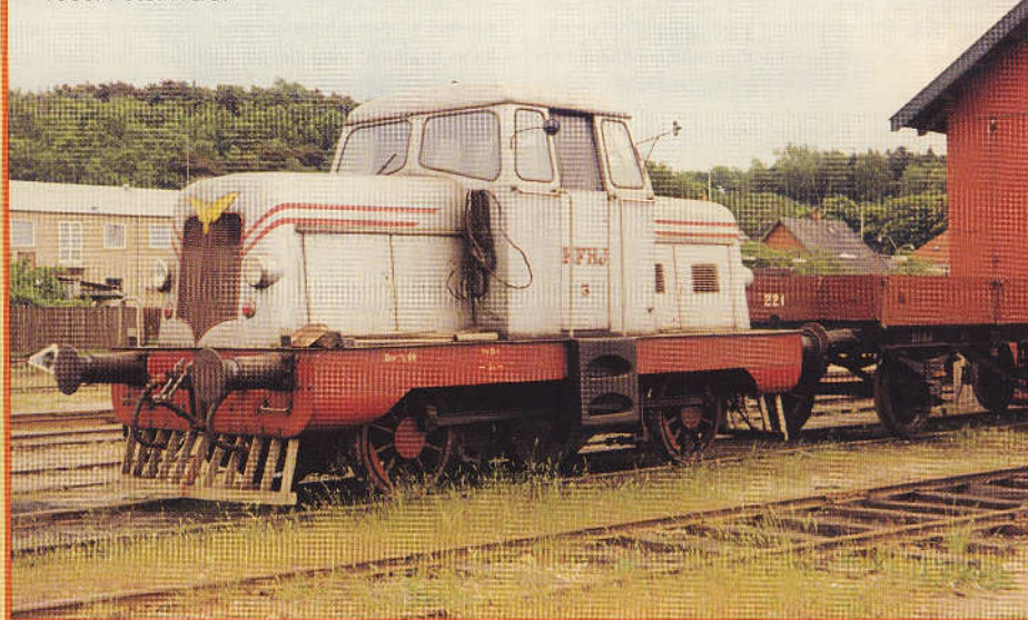
Den hjemmelavede traktor HFHJ T3, bygget på motorbogie fra M 7, i Frederiksværk, 1965. Foto: HGC.
