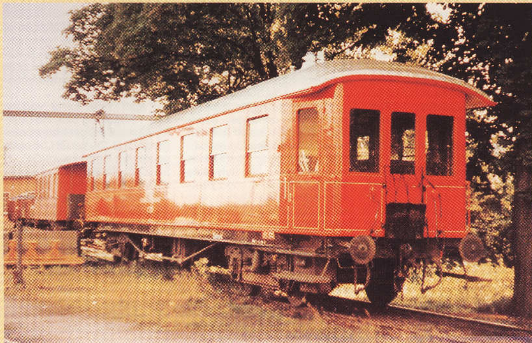
OHJ C 220 med lukkede spidse endeperroner, døre og vinduer m.v. i gavlene, Holbæk sommer 1965. Foto: Ukendt/Arkiv PÅ SPORET.
