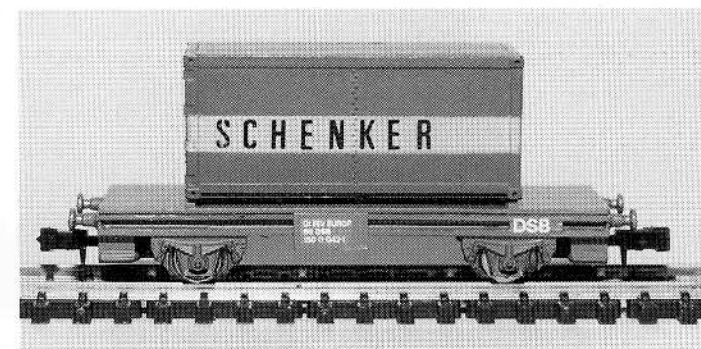
Det nederste foto viser vognen med container. Litreringerne er sammenstykket af diverse rester fra rodekassen. Vognen er brunmalet med Revell SM 381, der svarer til DSBs moderne godsvognfarve.
