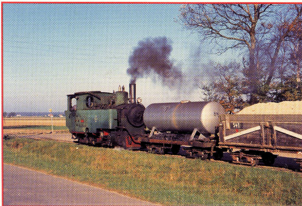
B.4 med tog ved Maribo, efterår 1965. Vandvognen tilhører B.4, hvilket fremgår af påskriften på beholdergavlen. Under beholderen ligger briketter. Foto: HGC.
