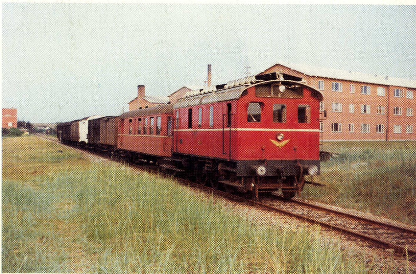
SB M4 med blandetog i Skagen, juni 1965. Toget er sammensat af person- og rejsegodsvogne fra SB og godsvogne fra DSB. Læg mærke til vindhjulet på fronten af lokomotivet. Foto: HGC.
