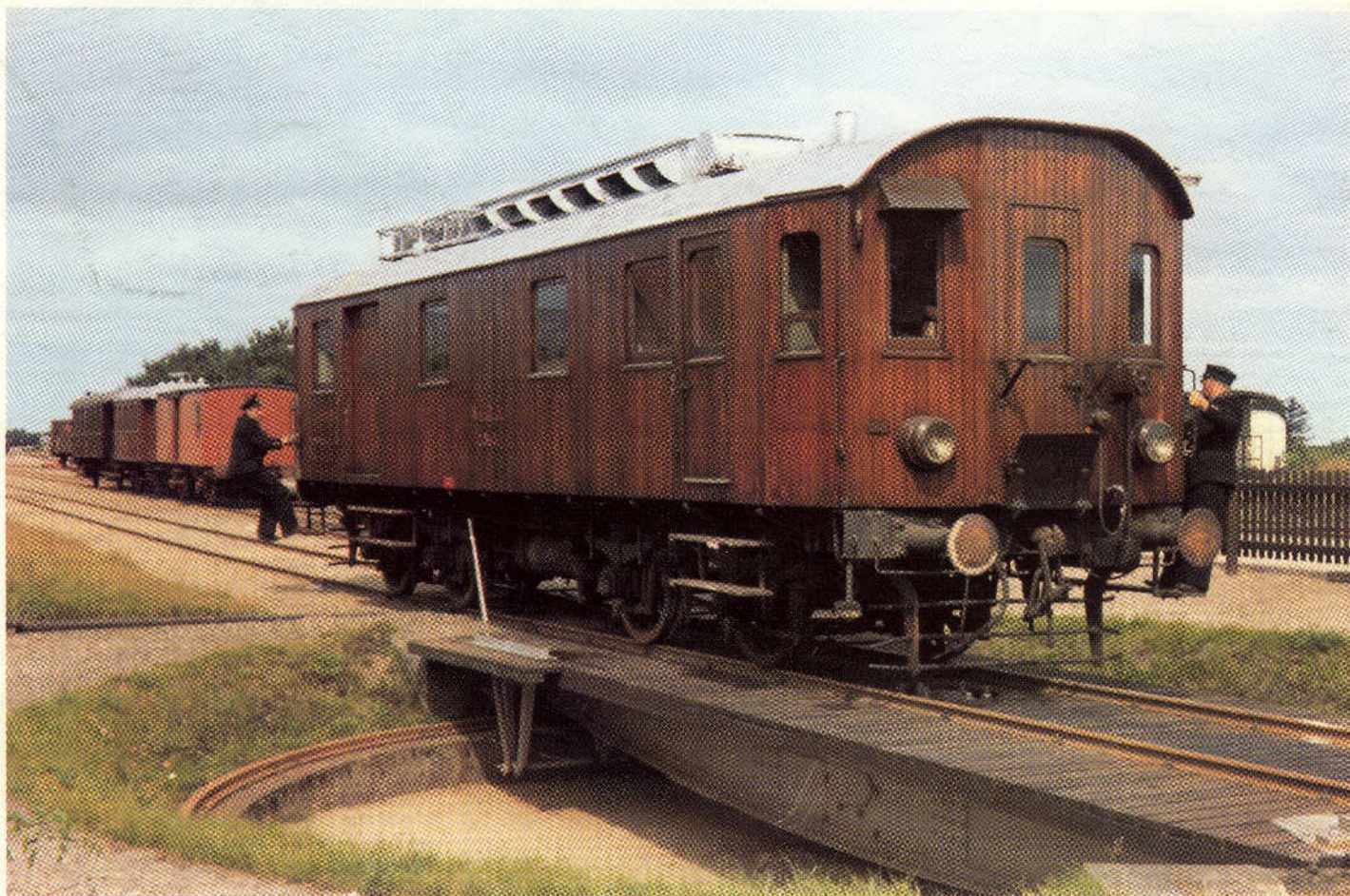
VaGJ M 1 var forsynet med en Holeby-motor, der var driftsikker og pålidelig. I 1964 var lokomotivet endnu i drift, og er her fotograferet på drejeskiven i Grindsted. Læg mærke til den velholdte teaktræbeklædning. Foto: HGC.
