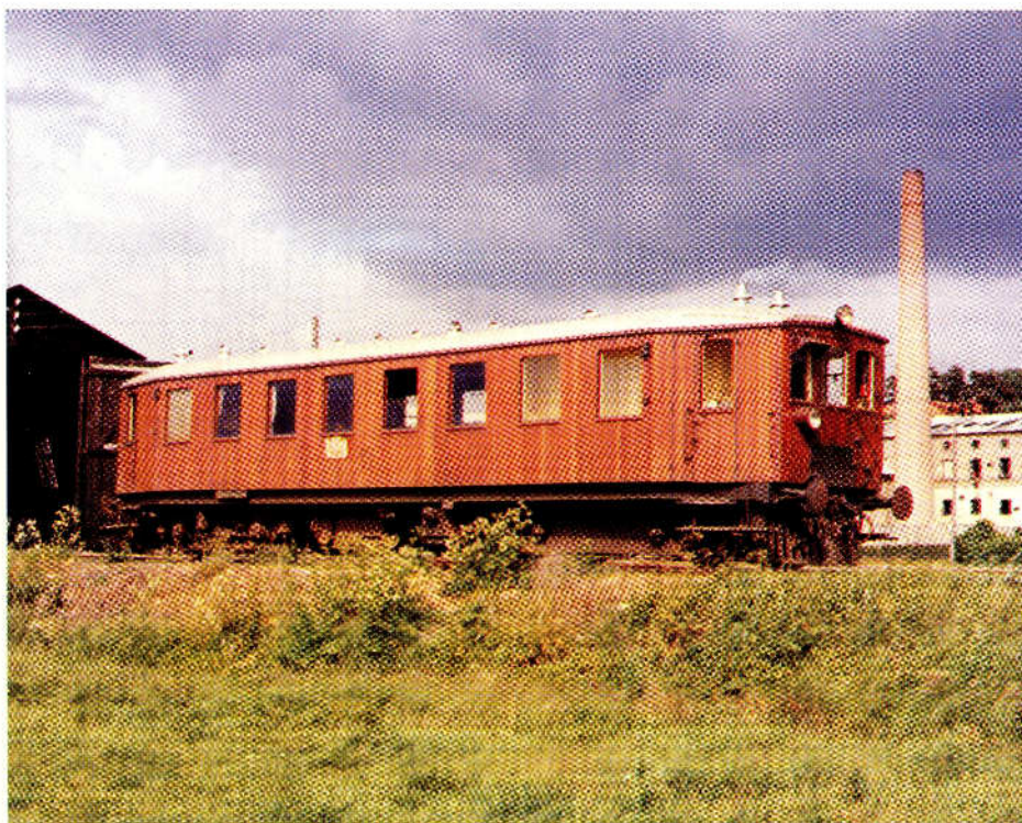
ETJ M 3 kom fra den lille Skive-Vestsalling-Jernbane i 1948, hvor den hed SVJ M 6. Den fik ligesom M 4 sine motorer udskiftet med GM-motorer. Ebeltøft, juni 1961. Foto: HGC.
