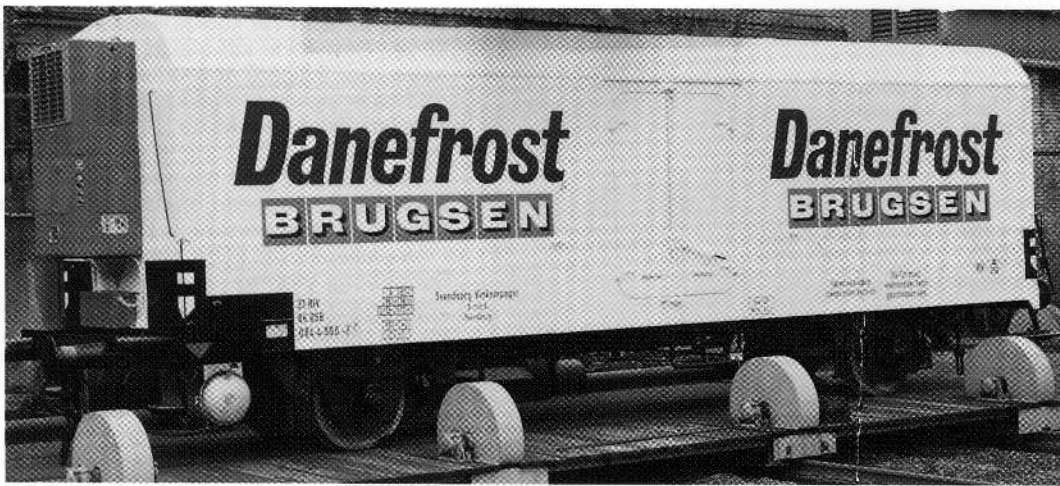
FDB fik bygget to specielle kølevogne af ældre IKA/lcs, idet undervognen forlængedes og der monteredes kølemaskine i gavlen. Her er 084 4 000-2 fotograferet på Cvk, 1970. Foto: P.C. Johansen.
