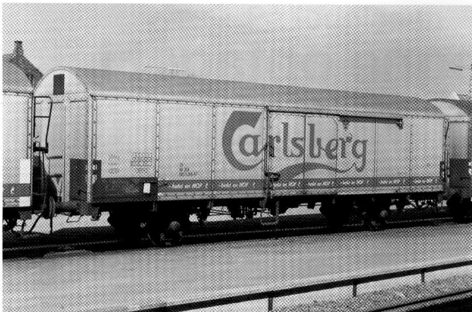
Lang Carlsberg-vogn 083 5 269-5 rangeres om bord på færge på Korsør station, april 1977. Bemærk det store U-trin under døren og lyshullet med grønt dækglas i gavlen. Foto: Torben Andersen.
