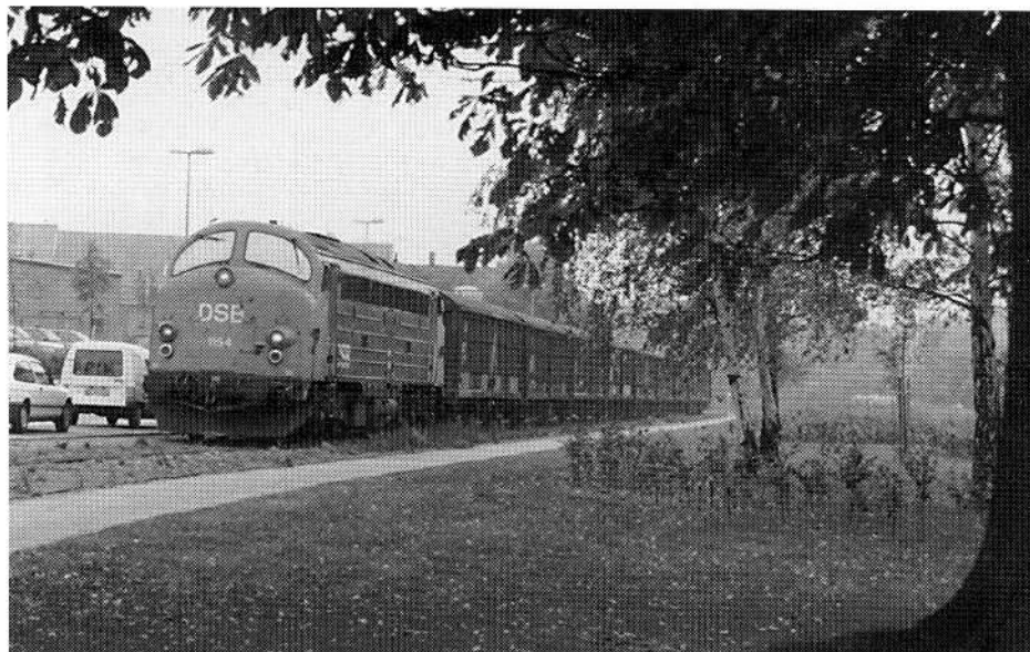
Enkelte MY fik midt i 80'erne monteret to røde slutlygter, og fik dermed i alt fem frontlanterner. Her MY 1154 med »papirtog« på Næstved havnebane ved IRMA-huset 1994, endnu før den fik rangerplatform. Foto: Torben Andersen.
