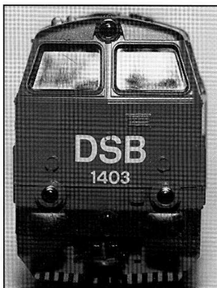
Front på den nyeste udgave af LIMAs MZ 1403 med lukkede hjørner på førerhusvinduer, underhængt plov og firkantede puffer
