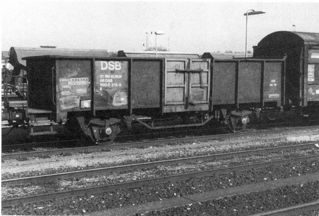
En rigtig blandingsvogn: DSB E-vogn med vognkasse i mørk brun nr. 3. Vognsider med hvide påskrifter er i RAL 8025 brun. Det samme gælder den tyske dør. Pletmalingen er udført i en kraftig rustrod dækfarve. Akselboksene er gule.
