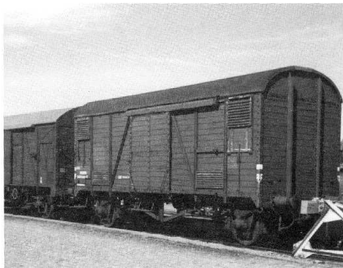
Hvid tjenestevogn ex. IAR ommalet i DSB-brun nr. 3, Næstved 1981. Vognen har mørkegråt tagpap, men vejr og vind har gjort vognkassefarven lysere i nuancen. Foto: Steffen Dresler, Næstved
