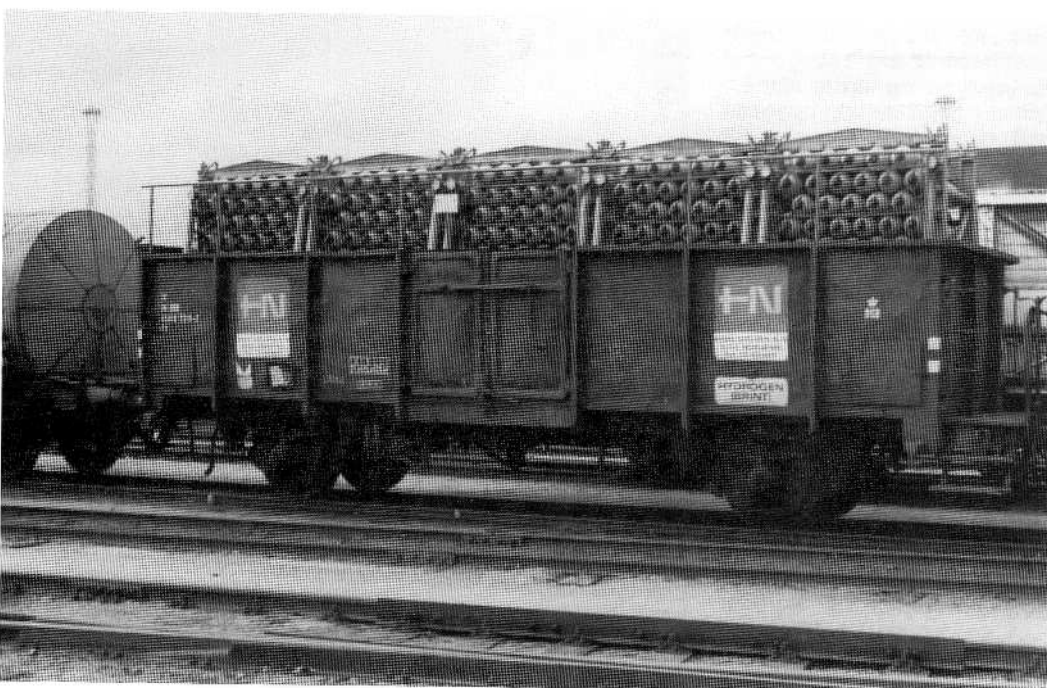
Fk 650 0 209-2 var en E-vogn, der sammen med andre, omdannedes til transport af flydende hydrogen (brint) for Hede Nielsen A/S, Horsens. København 1977. Foto: Torben Andersen.
