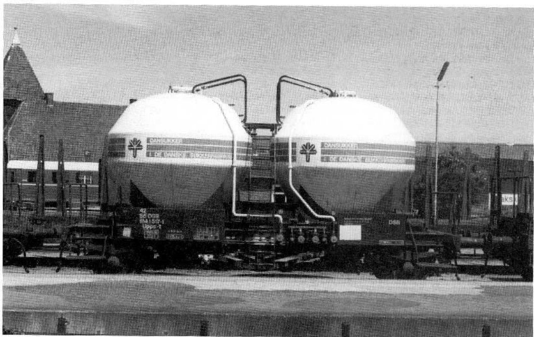
DSB Upps-t 914 1 517-1 i Nakskov, 1984. Til forskel fra søstervognene Ucs havde typen ekstra forhøjede håndbøjler ved beholderne. Foto: Torben Andersen
