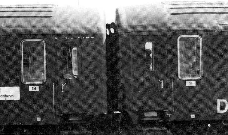
Her ses tydeligt forskellen på en B-vogn før og efter ombygning af dørpartiet. Vognen til højre er ombygget, og har fået mindre vindue i døren, samt »trekant« i gavlen under elvarmestikket, 1984. Foto: Torben Andersen
