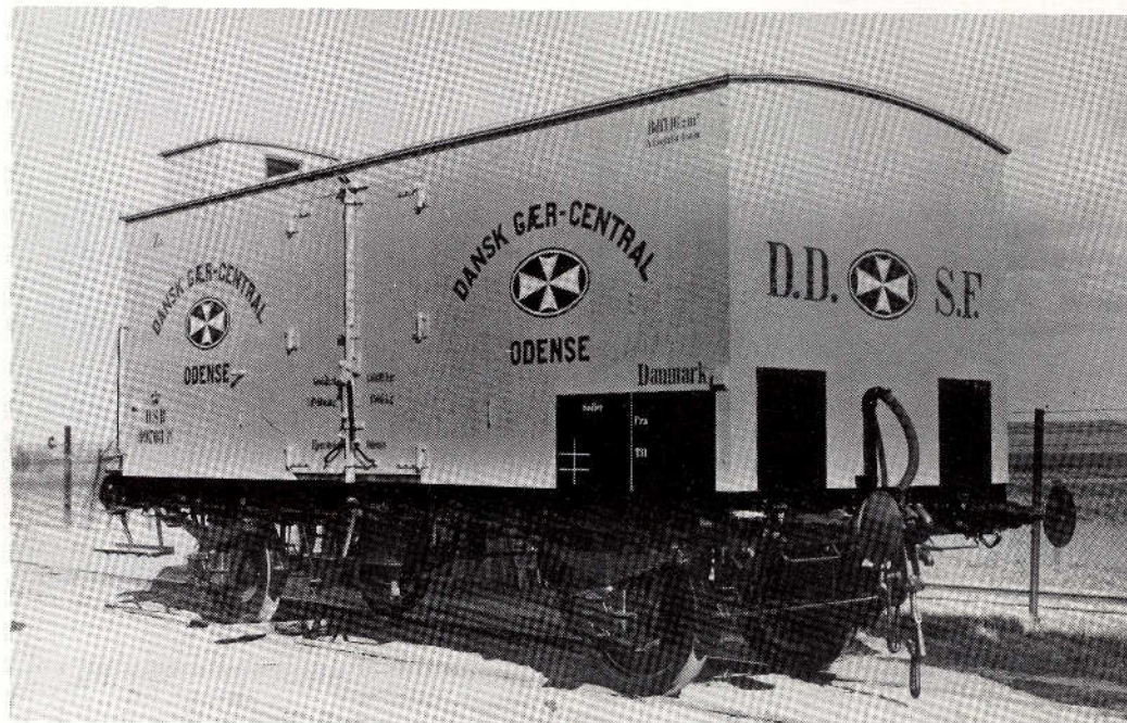
ZB 99 703 ved leveringen fra Scandia i 1929. Som det fremgår af billedet bærer den påskifterne DANSK GÆR-CENTRAL, ODENSE, der var datterselskab af DDSF, hvis bomærke ses i gavlen. Vogne har tårnbremse og vakuumledning. Vognen endte sine dage hos OHJ. Foto: Scandia/JMJK.
