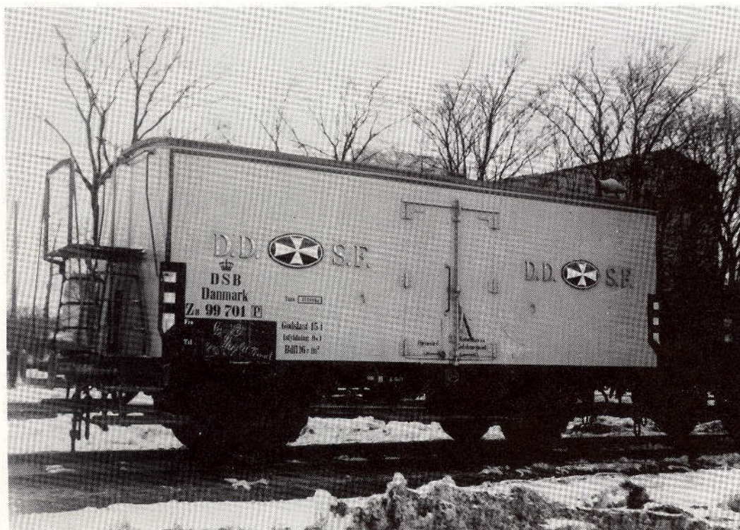
En af de gamle gærvogne ZB 99 701 fik efter fjernelse af bremsetårn højsiddende rangerskruebremse som søstervognen ZB 99 702 (de øvrige fik lavtsiddende med håndhjul i gavlen). Den blev udstyret med godstogsbremse, der kunne omstilles til ikke internationalt godkendt persontogsbremse. Her ses vognen i Slagelse omkring 1947 (revisionsdatoen
