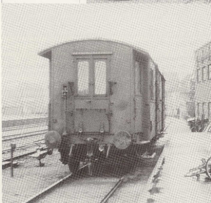
Ex. DSB ECO som HFHJ DK 76 i Hillerød 1963. Bemærk døren, der er omdannet til indvendig skydedør med ét vindue. Foto: Chr. Oddershede
