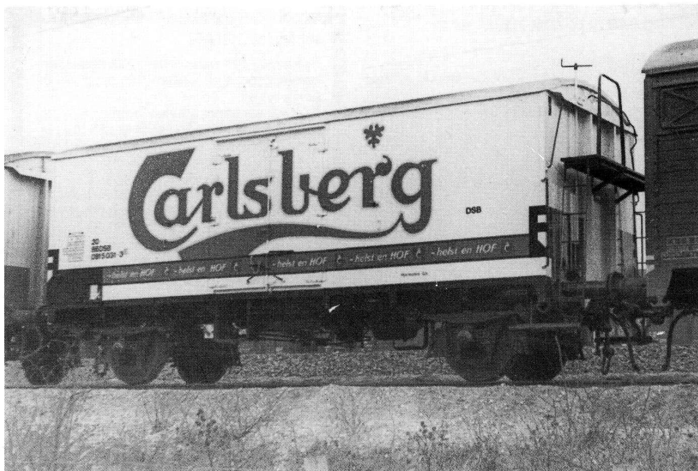
ØLVOGN FRA 1959: En Carlsberg-ølvogn, der til forveksling ligner den »langbenede« (omtalt i nr. 29). Her 081 5 031, før 1966 ZA 99 331, bygget Scandia 1959. Vognen kendetegnes ved akslernes placering længere inde under vognkassen, og på den manglende V-armering. Læg mærke til påskriften; det grønne bomærke er outlined med en grå, næsten pastelgrøn farve. Vognkassen har samme dimensioner som ølvogne bygget 1946–54. Foto fra København, marts 1977. K.E. Jørgensen, Hvidovre.
