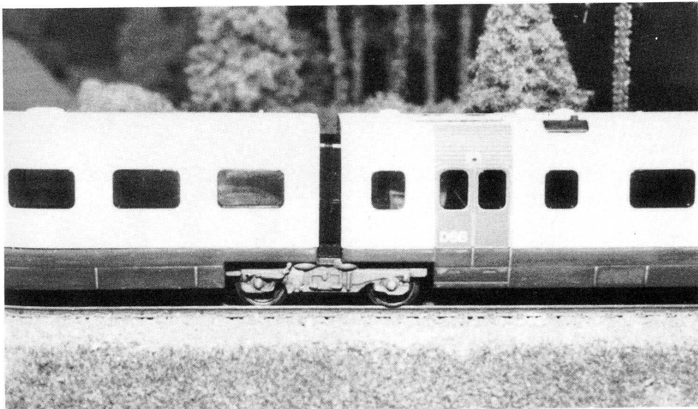
IC3-midtervogn og motorvogn med nye bogiesider. Sammenlign med fotos af bogier fra originalmodellen i sidste nummer, side 66.
