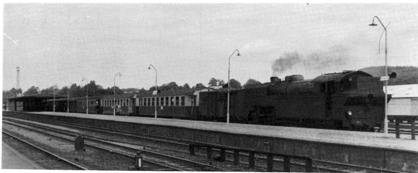
Tog fra privatbanen kunne motivet hedde. Men det er i Hillerød, hvor S 738 har fat i 2 HFHJ CL-vogne og nogle ældre vogne, deriblandt en af de berømte »Kuhlmann-cars«. Maskinen kører ikke retvendt, da man ikke vendte maskinerne i Hillerød før tilbagekørsel til København. Foto fra 1960. Foto: HGC, Odense.
