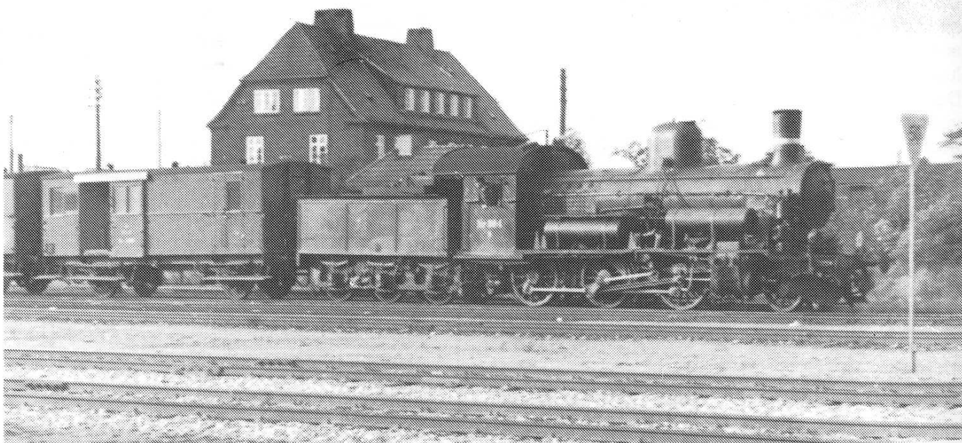
ER DET IKKE ET DEJLIGT SYN? En EH-vogn efter en D-maskine under rangering på Brande Station, juni 1960. Lokomotivet er D 804, mens EH-vognen bærer nr. 6805. Vognen har fået fjernet kukkassen, og der er allerede påsat U-jern på gavlene. Foto: JB-P, Ribe
