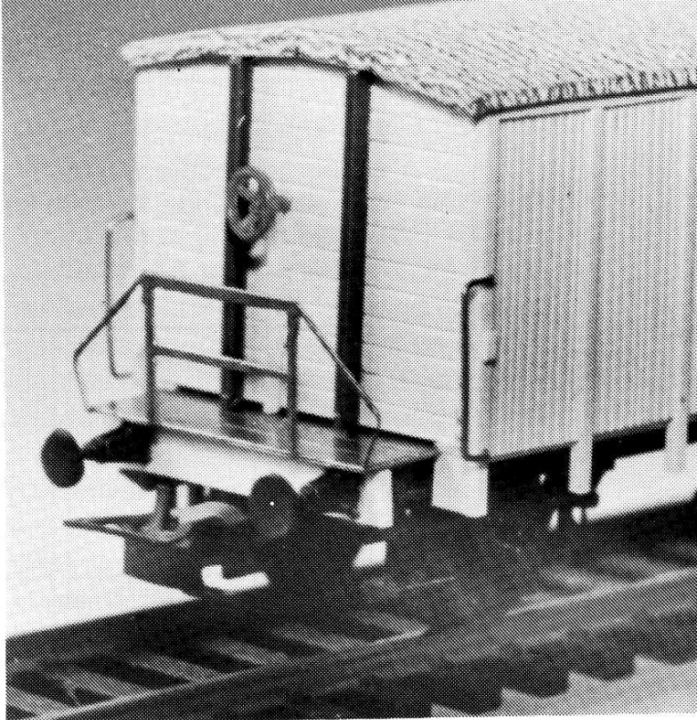
Her ses IB-vognen fra bremseplatformsgavlen. Læg mærke til at gavlvæggen har bredere brædder end vognsiderne. Bemærk også håndhjulets placering, og profiljernene på gavlen. Platformen er af ætset messing, og kan købes hos PÅ SPORET. Vognen er bygget af Claus.
