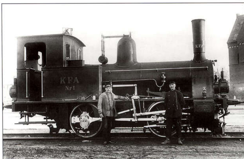
Til venstre: Det 2-koblede damplokomotiv KFA 1 i Frihavnen, 1920. Lokomotivet var magen til DSBs rangermaskiner litra HS. Foto: KFA.
