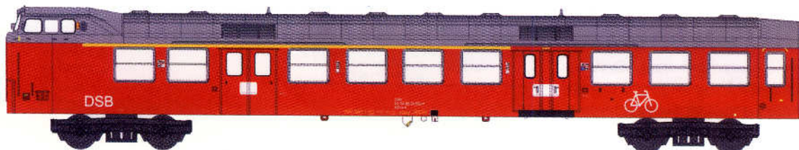
DSB nærtrafikvogn litra ADns-e. En korrekt model af styrevognen til EA-fremførte tog.
