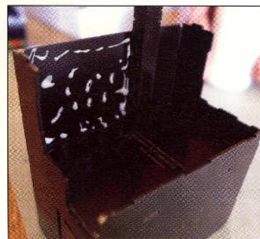
Fig. 12: Punktlimning af E-4
