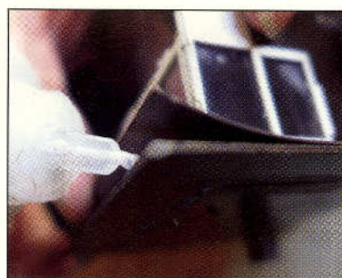
Fig. 23: Til sidst prikkes lim et stykke ind i mellemrummet mellem D-6 og A-8, og D-6 klemmes på plads.
