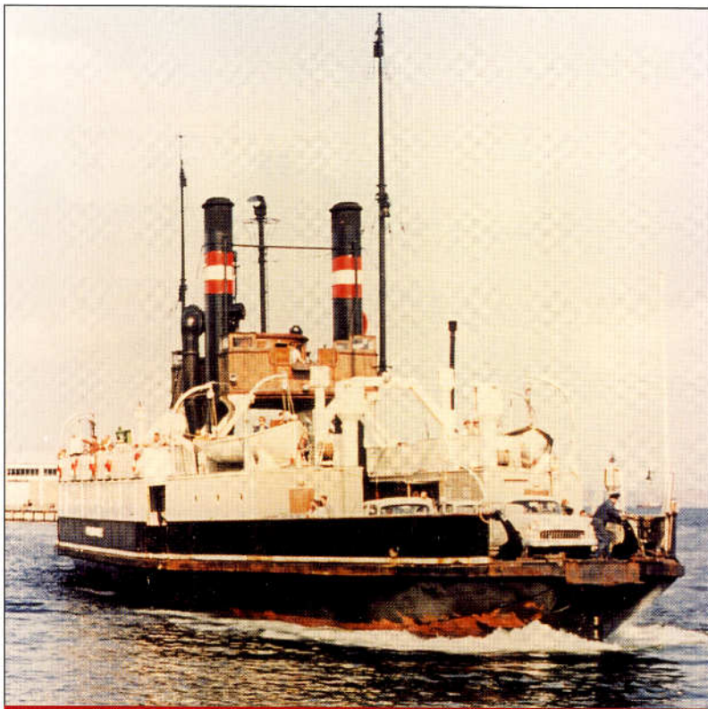
Dampfærgen GLYNGØRE under sejlads på ukendt farvand. Den enkeltsporede færge havde karakteristiske høje sideplacerede skorstene og såkaldt 'svævende bro', d.v.s. en kommandobro, der var anbragt 'særskilt' over bil- og jernbandedækket. Færgen, der var enkeltsporet, blev efter levering indsat på ruten mellem Helsingør-Helsingborg. Den kunne sejle lige godt i begge retninger, idet den havde en skrue i hver ende. I 1946 blev den indsat som reservefærge på Sallingsund (Nykøbing M-Glynngøre), hvor den samme år omdøbtes til Glynngøre. Færgen har også været anvendt som reservefærge Fåborg-Mommark. Den blev udrangeret i 1964 grundet nedslidte kedler. Foto fra omkring 1960.
