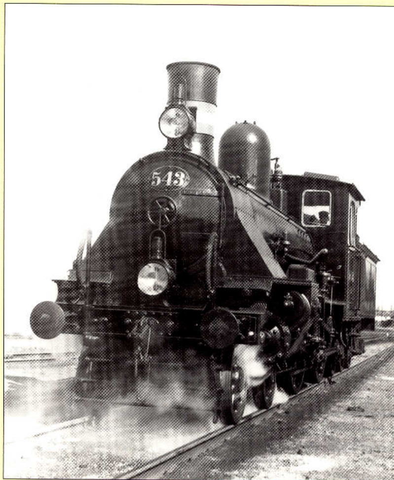
K 543 nyrevideret efter ombygning med overheder, 1935. Foto: Jernbanemuseet.
