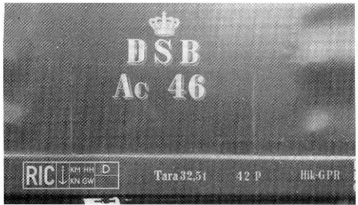
Tekniske påskrifter på AC 46. I RIC-rammen efter ankeret anes signaturerne KM, HH, KN og GW. Bogstavet D angiver at vognen må køre i Tyskland (Deutschland). Foto fra 1961. K.E.Jørgensen.
