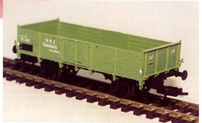
Herunder: Ingen af de benyttede grundmodeller har håndbremse, idet fabrikanterne har valgt af fremstille O-vognen i den oprindelige tyske udgave. For montering af dansk håndbremse, se side 6 øverst.
