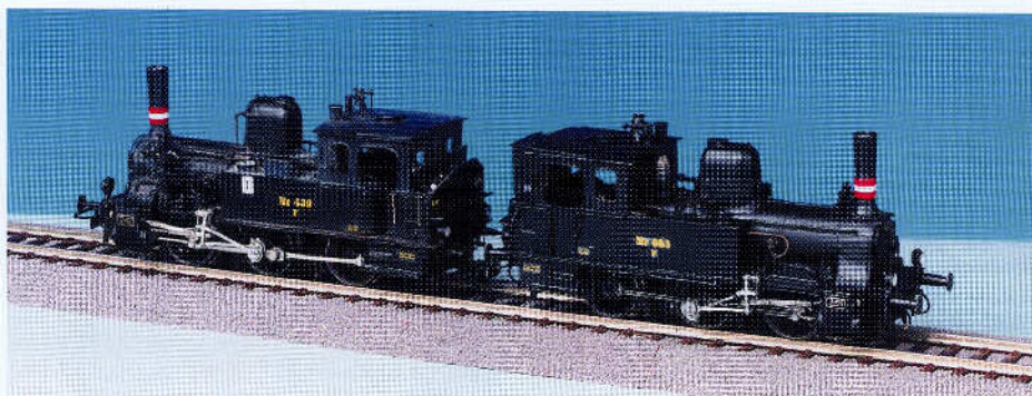
F-maskine-Gruppen, Vejle, fremstillede i 1997 et yderst detaljeret byggesæt af det klassiske DSB-lokomotiv litra F. Hoveddelene var i ætset nysølv med diverse løsdele, bl.a. støbt i hvidmetal og messing.
