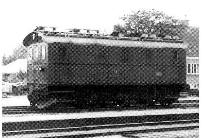
Aalborg Privatbaners FRICHS-maskiner var malet i en kirsebærrød farve med sort mavebælte. FFJ ML 1209 med tog, 1963. Bemærk banerømmerne, der er "hakkede". Foto: Claus.
