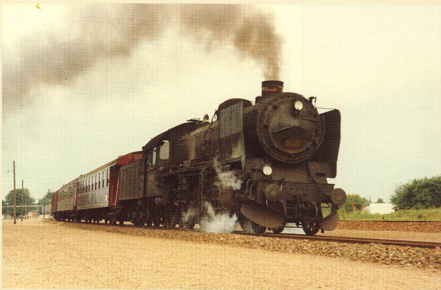
Herover: R 959 med lille persontog (CL-B-ECO) på vej fra Fredericia til Nyborg, fotograferet ved Langeskov på Fyn, 1968. R 959 blev leveret af FRICHS i 1924, og var en af de R-maskiner, der havde røgkammerdør med vridere i stedet for centerstillet håndhjul. Maskinen var i 1960'erne reserve i Fredericia, hvorfra den kørte en del særtog. Foto: HGC.
