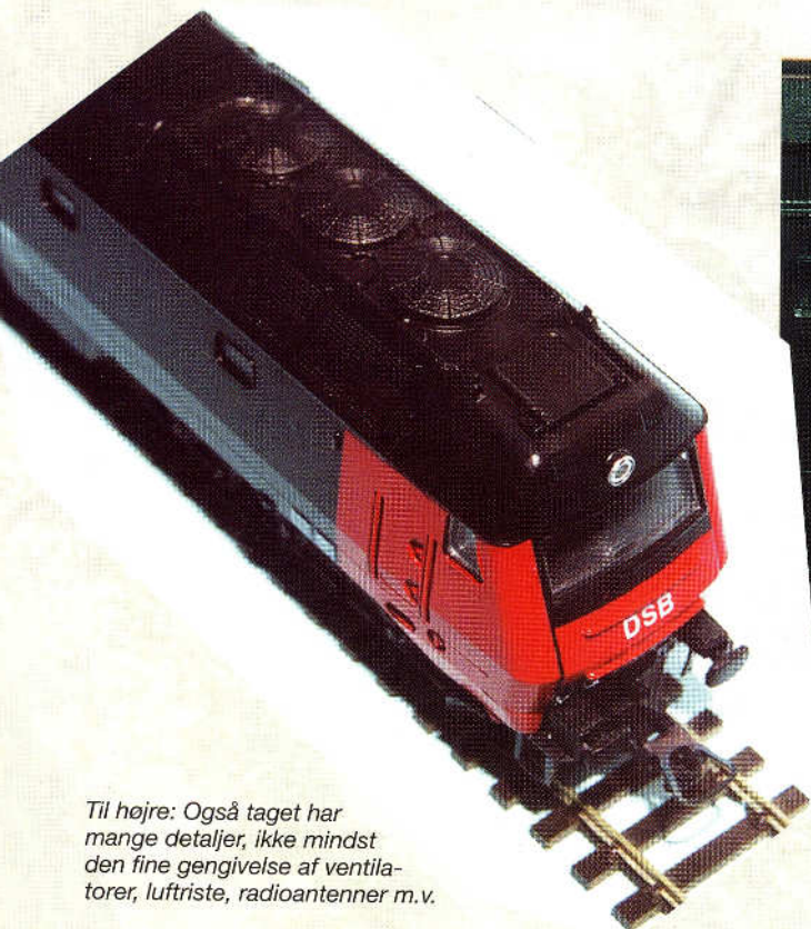
Øverst: Hobby Trades model af DSBs moderne diesellokomotiv litra ME er en fin gengivelse af maskinens karakteristika med skrå fronter og sider. Herover: Modellen har alle detaljer, lige fra indfældede håndgelændere, trin og håndtag, rangertrin og underhængte plove.
