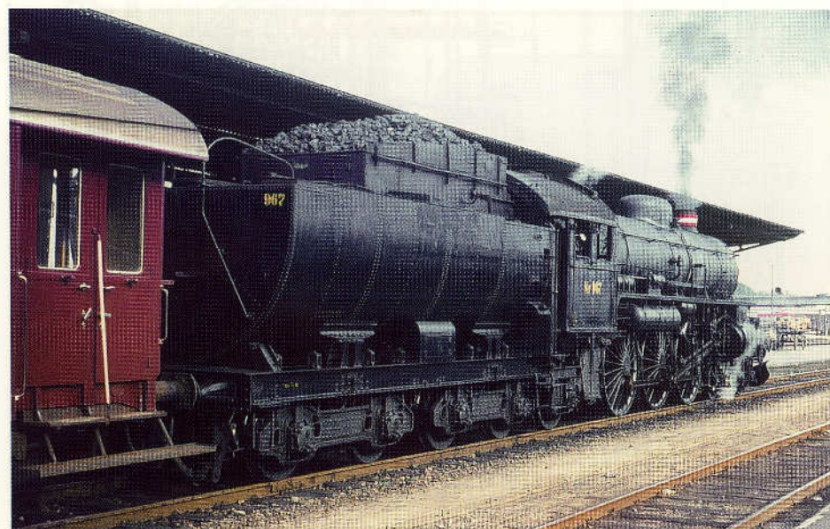
De svenskbyggede E-maskiner havde en karakteristisk nittede tender, her en af typen som påhæng til E 967. Bemærk, at kullene er læsset til "op over ørerne"...E-maskinen skulle have meget at "spise". Foto fra Aalborg 1958 (?). Foto Møbius/PÅ SPORET.
