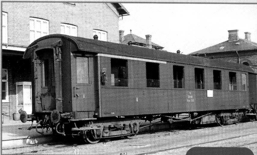
En slidt og næsten udtjent AT 220 fotograferet i Bramminge, 1965. Læg mærke til gardiner for de delte vinduer, og harmonikaer i slidt lysegrøn farve. Tagventiler (wendler og toiletventil) er i lysegrå. Foto: Guldbæk/Arkiv JMJK.
