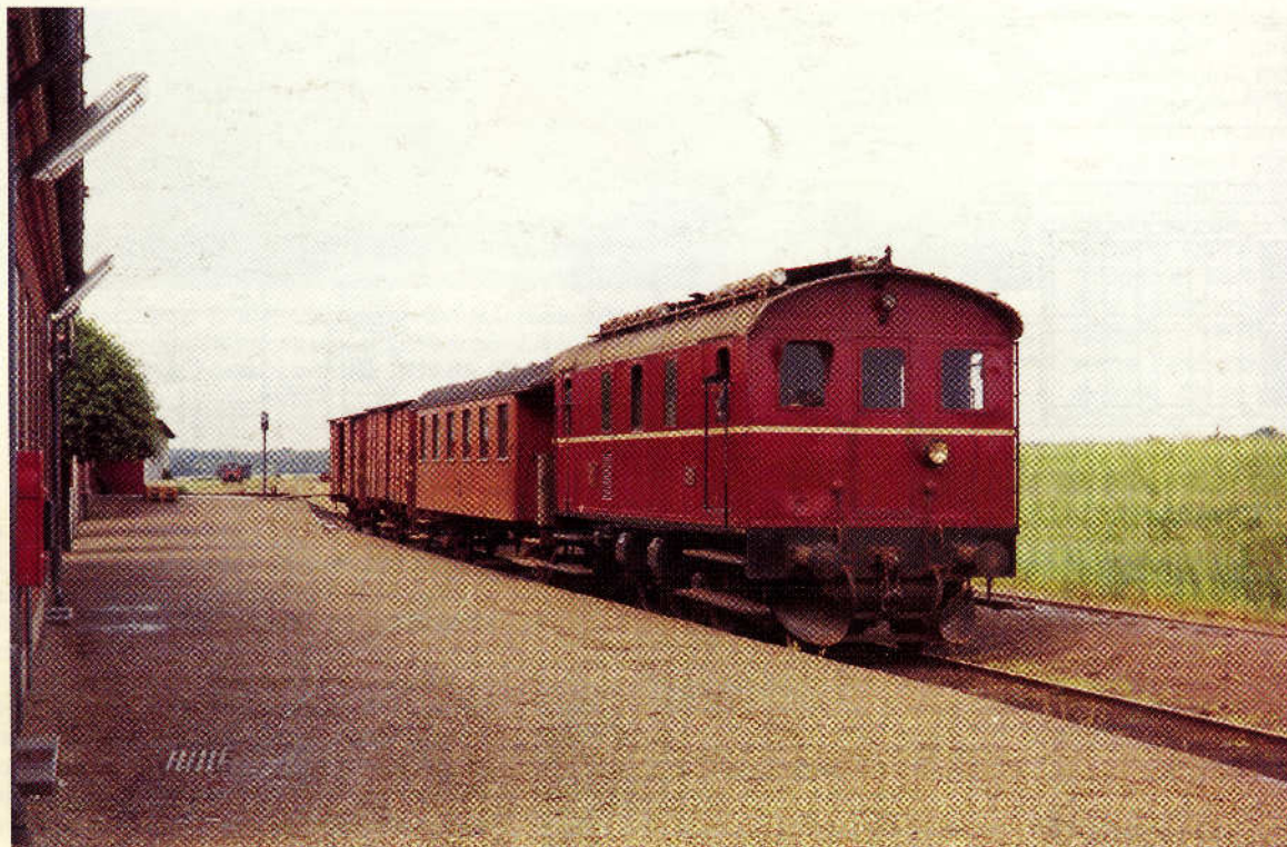
Et rigtigt privatbanetog fra begyndelsen af 60'erne: TKVJ M4 med blandetog i Vorbasse på vej til Kolding, 12. juni 1961. Selv om billedet er lidt mørkt, så kan man sagtens se, at mavebæltet er cremefarvet og at vognkassen er mørk rødbrun. Vognene er en 2-akslet teakpersonvogn med åbne endeperroner fra TKVJ og et par lukkede godsvogne. Foto: HGC.
