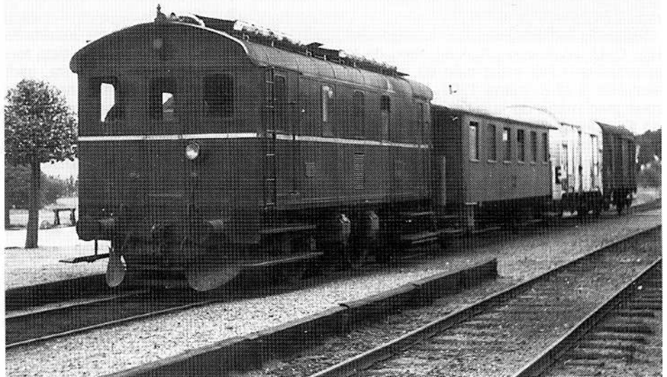
TKVJ M 4 (med rev.-år 1964) gør holdt med blandetog i Trolldhede, 1966. Lokomotivet har cylinderpuffer, runde snenæser, blændet endegavl samt lejder til taget. Foto: Guldbæk.
