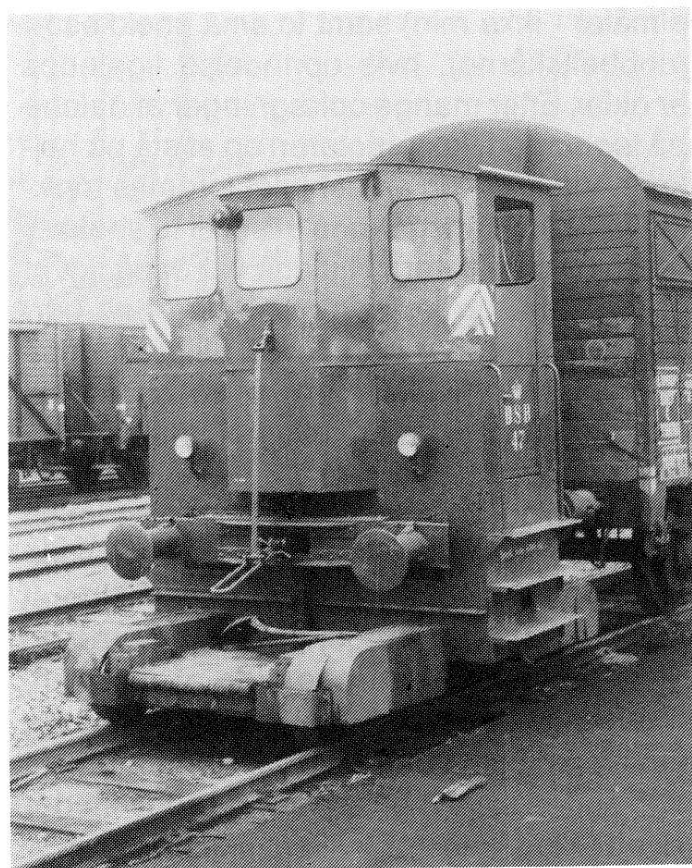
Begge fotos: DSB »klædeskab« nr. 47, der er forbillede for Vagn Holsteins model, her fotograferet ukendt sted under rangering med G-vogn i 1967. »Skabet« er malet i DSB-grøn med gule litreringer, og har fået gule advarselsstriber. Tekniske påskrifter under døren lyder: Tjenstf. vægt 6300 kg. Bemærk skovlen på ladet (nederste foto), og den øjeformede koblingskrog. Foto: Guldbæk Christensen, Skødstrup.
