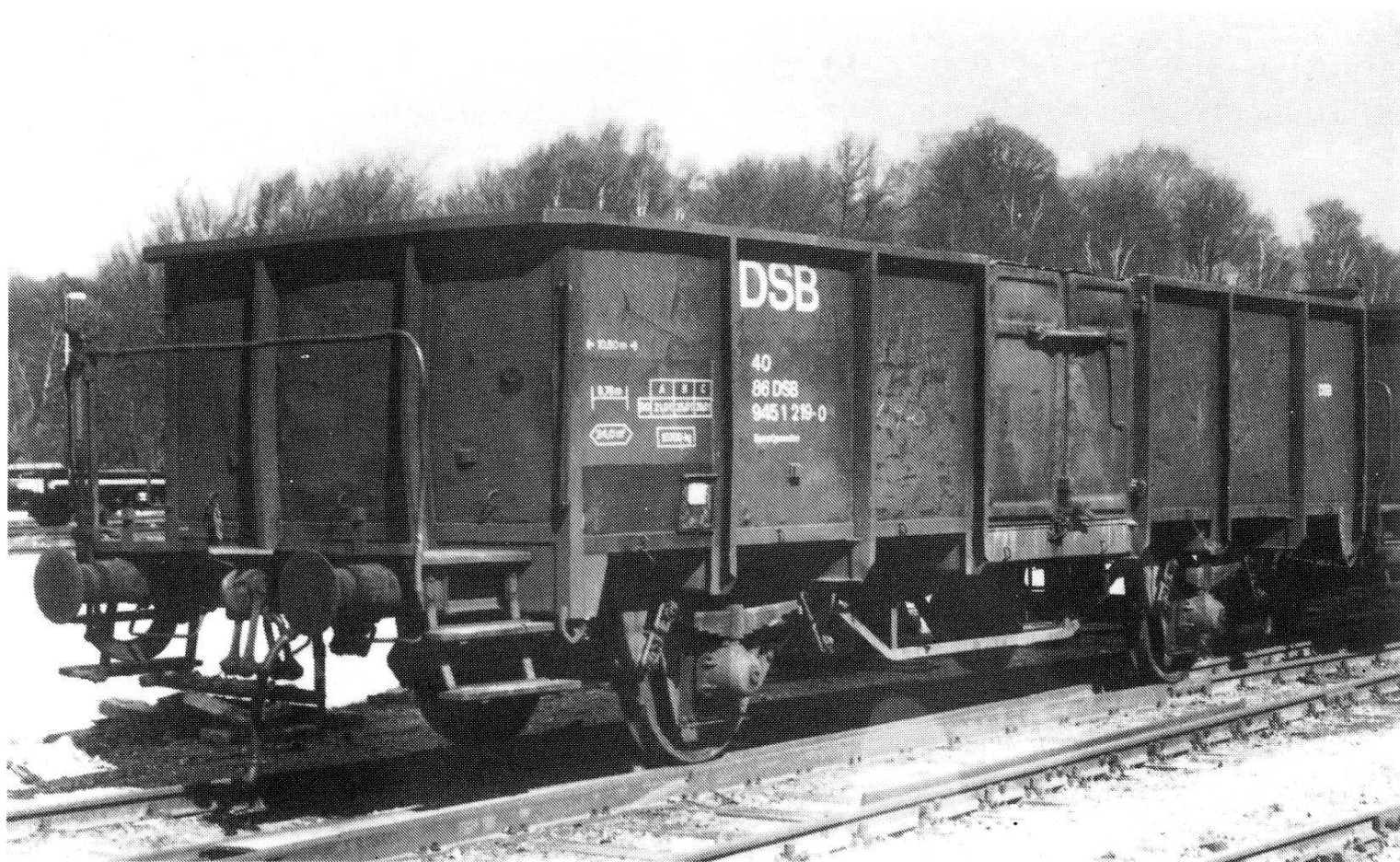
E-vogn: 40 86 945 1 219-0 i Fredericia, april 1988. Fotograferet fra enden med rangerskruebremse, således at udseendet tydeligt fremgår af billedet. Bemærk slidte trin og hvide løbestriber under døre. Sider og gavle er bulede.
