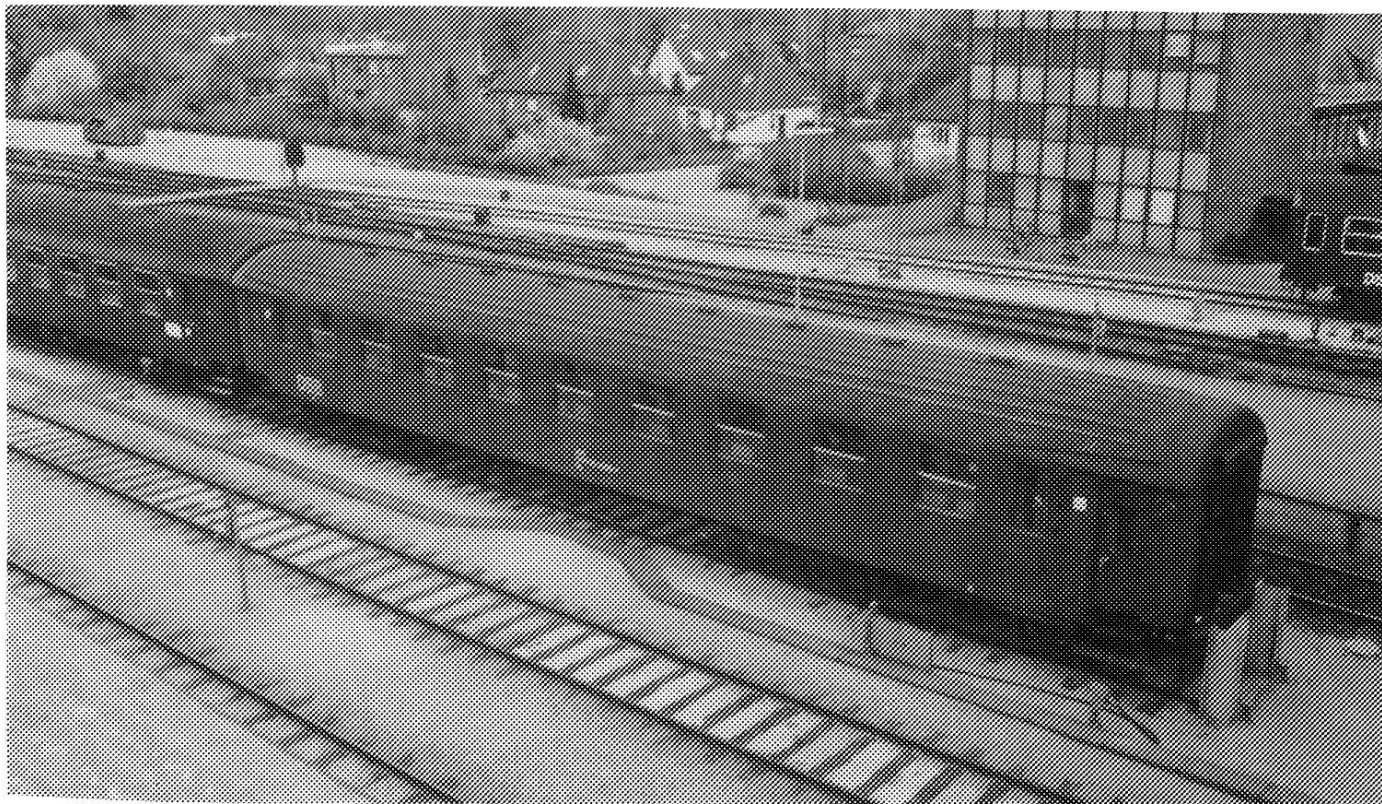
Bg (ukendt nummer) i Korsør, 1989. Knækket ved dørpartiet ses tydeligt. Bemærk, ingen deling af små vinduer i denne side.
