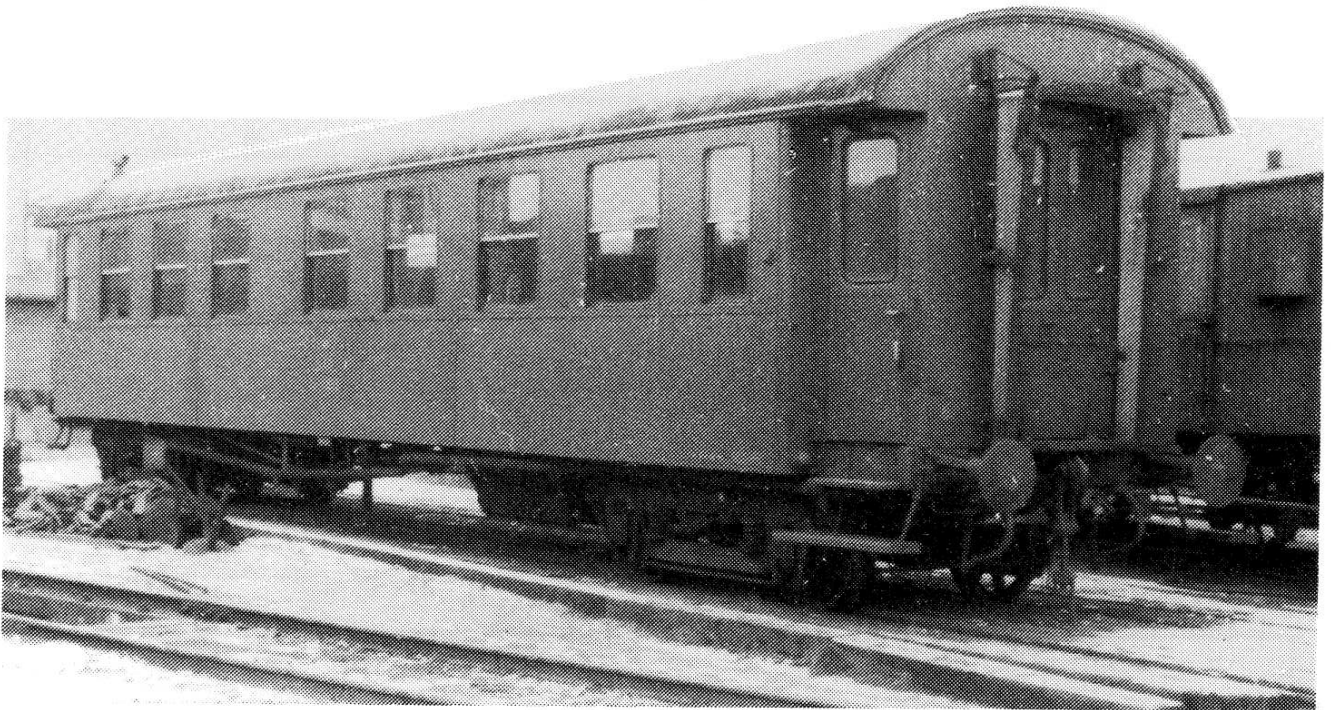
Én af mange! CP 3252 i Odense, 1965. Vognen er (selvfølgelig) af samme type som midtersidetegningen. Dog bør man bemærke, at dørvinduet har runde hjørner med gummitætningsliste, hvilket ikke var typisk for CP-vogne, så vidt vi har kunnet finde frem til. Foto: K. E. Jørgensen, Hvidovre
