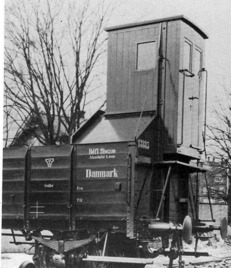
Da PJ-vogntypen blev bygget i 1924, byggede man også et antal med bremsetårn. Tårnet blev senere afmonteret, og vognene fik litra PJR. Fotoet viser »tårndelen« af PJ 13 885, fotograferet hos Scandia i 1924.
