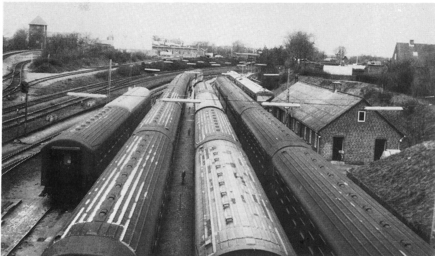
Fig. 3: Vognvaskepladsen i Esbjerg, set fra Frodesgadebroen den 12/4-83. Læg mærke til, at kuck-kuck-ventilerne ikke er placeret ens på alle vogne.
