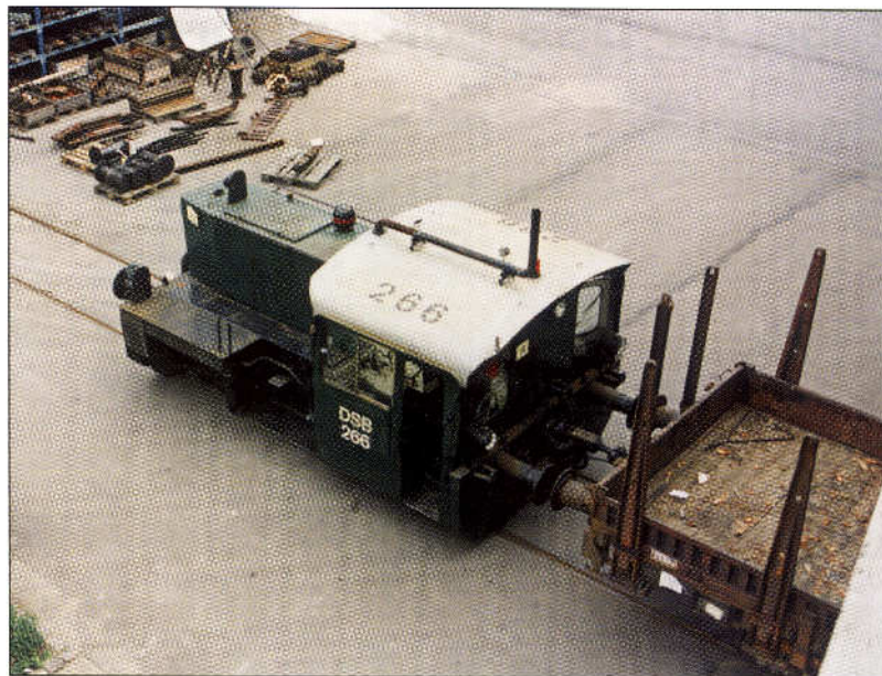
Köf 266 efter montering af ny forlænget skorsten, opmalet i grøn og sølvfarvet tag med hvidt DSB-logo - og sort nummer på taget, det såkaldte flyvernummer. Traktoren er fotograferet ved Godsbanegårdens materieldepot, 1992. Foto: TA
