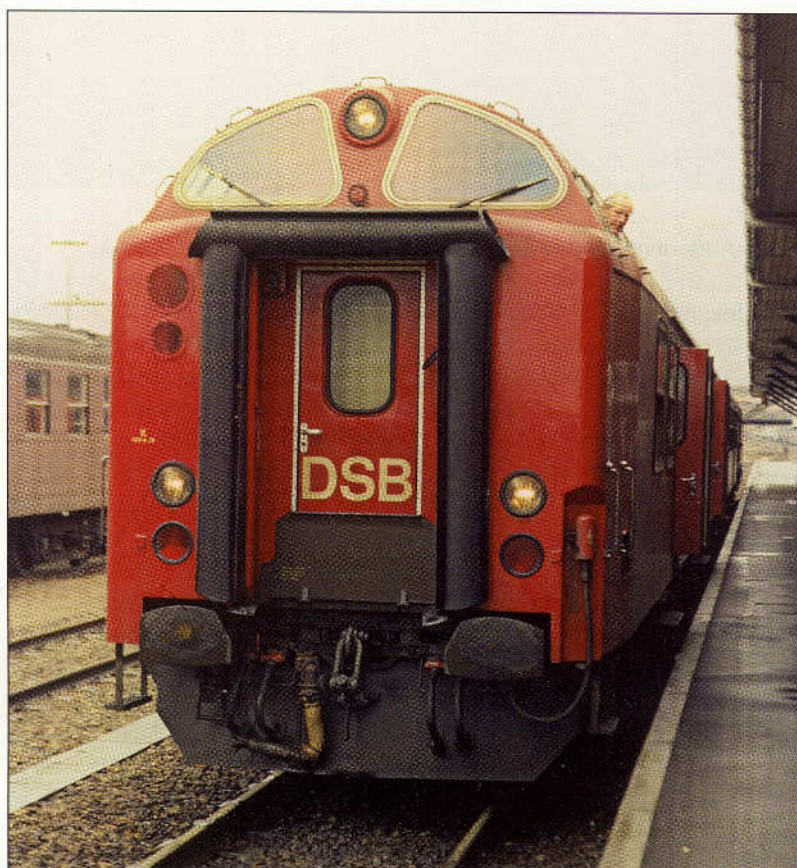
Bns (serie II) foran regionaltog til Køge, Næstved 1977. Her kan man tydeligt se fronten med gummivulst, dør, overgangsbros, triangellys, sluslygter og det skrå skørte på undervognen.
